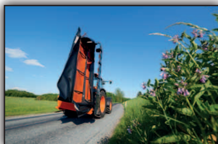
En transporte la máquina se pliega hidráulicamente en posición vertical tras el tractor, facilitando el desplazamiento entre campos.
