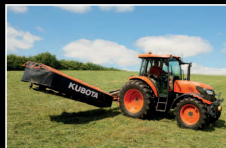
Alzado en caberas mediante cilindro hidráulico, sin utilizar el tripunthal del tractor.
