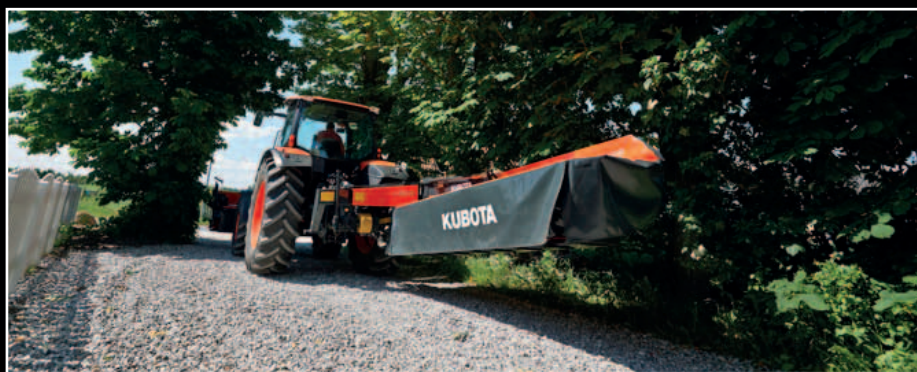
Las segadoras basculan hacia atrás para situarse en posición de transporte, horizontalmente respecto al terreno. El paso de una posición a otra se realiza desde la cabina del tractor.
