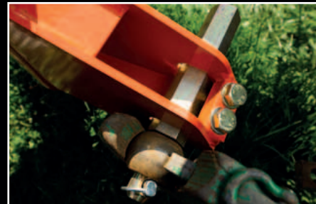
Los bulones de acoplamiento ajustables facilitan la adaptación de la máquina a la anchura del tractor.
