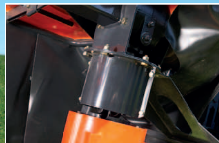
Accionamiento directo al primer disco para una eficiente transmisión de potencia.
